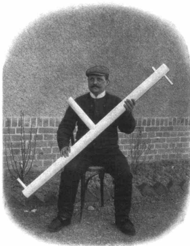
Fig. 5. Beueler Quarzgitrohr mit angeschweißten Stützen.
